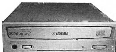
*Yamaha подготовила к выставке CeBit-2001 привод CD-RW/R со скоростной формулой 20x10x40. Если для записи CD объемом 650 Мб на обычном приводе (x2) требуется 40 минут, данный привод справится с этой работой всего за 3 минуты*
